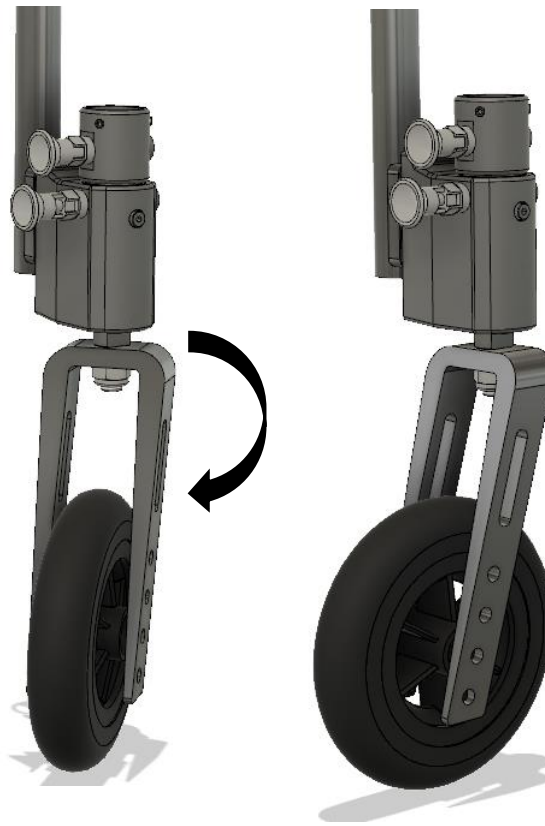
Figure 11 - Réglage de la fourche en position droite
